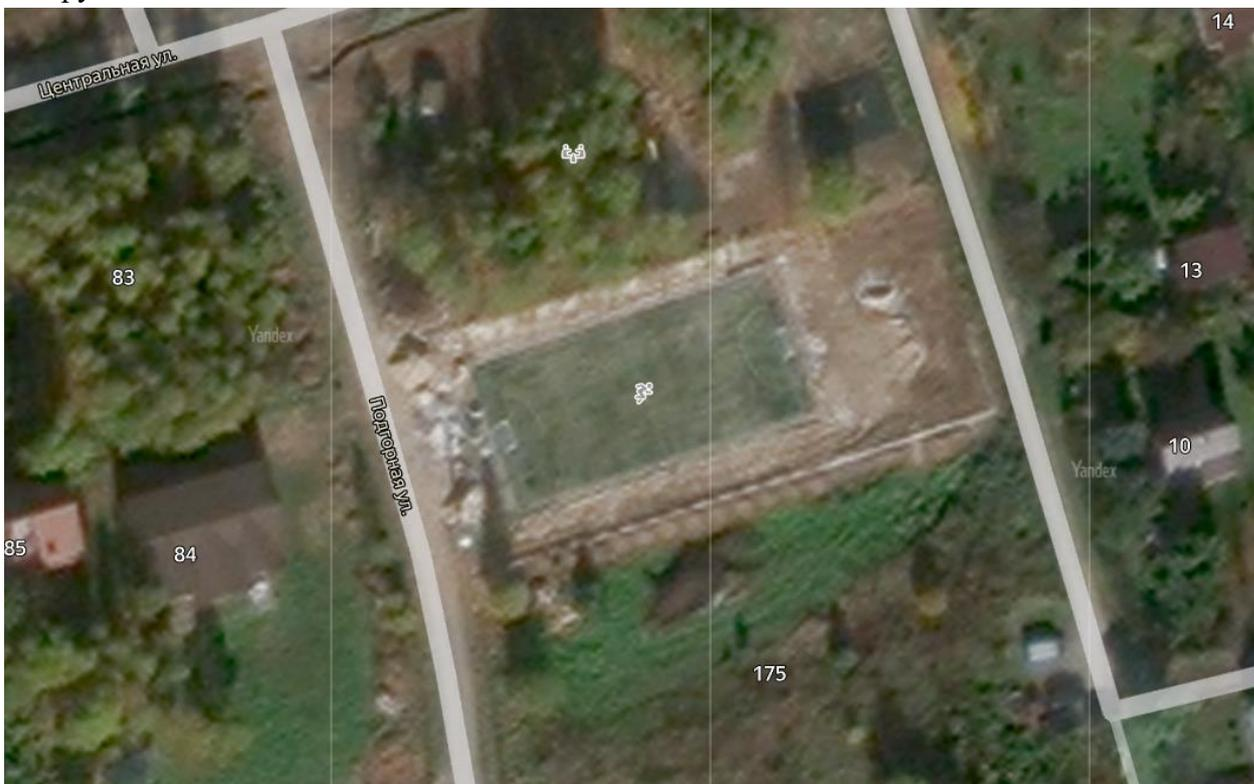
Фото 32. Спутниковый снимок процесса вертикальной планировки спортивной площадки и футбольного поля. Весь объем земли полученный при выемке грунта был использован в насыпи пазух вдоль монолитной подпорной стены без вывоза грунта с объекта.
